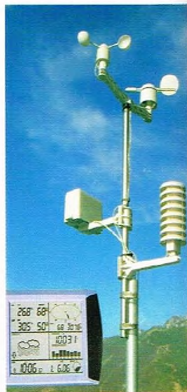
El ProWeatherStation es una estación meteorológica inalámbrica que proporciona, entre otros datos, la sensación térmica.
