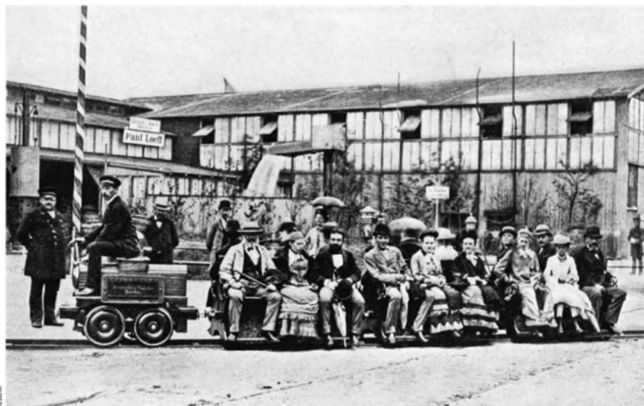
Sobre estas líneas, fotografía del primer tren de pasajeros eléctrico del mundo en el que la energía se suministraba a través de los rieles, 1879, de la empresa Siemens & Halske (1879).
