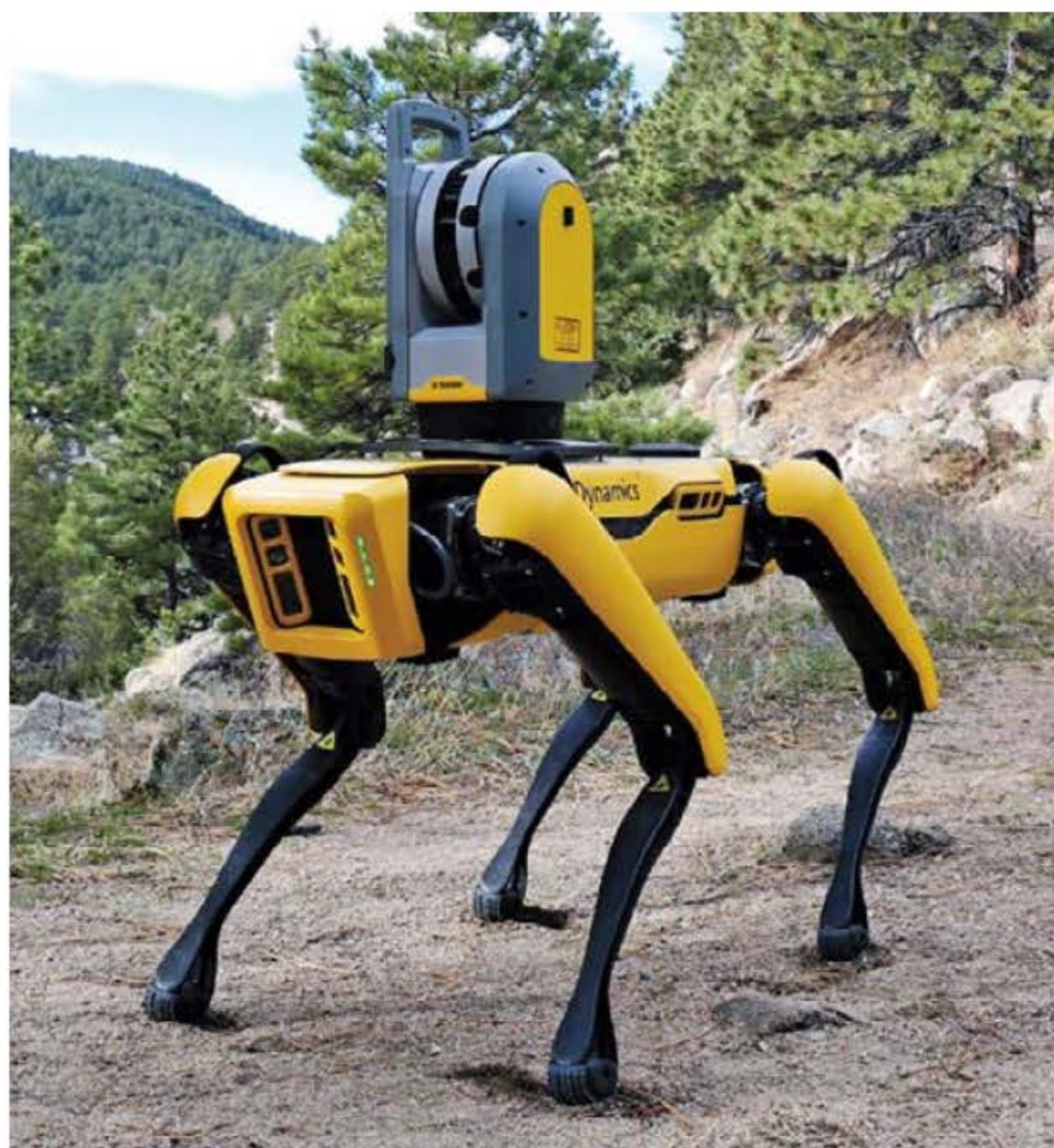
Sobre estas líneas, Spot, el perro robótico de Boston Dynamics, que puede subir escaleras, abrir puertas, activar mecanismos, transportar objetos o salvar obstáculos. A la izquierda, arriba, TOPIO —un robot humanoide bípedo diseñado para jugar tenis de mesa contra un ser humano—; abajo, Aibo, el perro de Sony.
