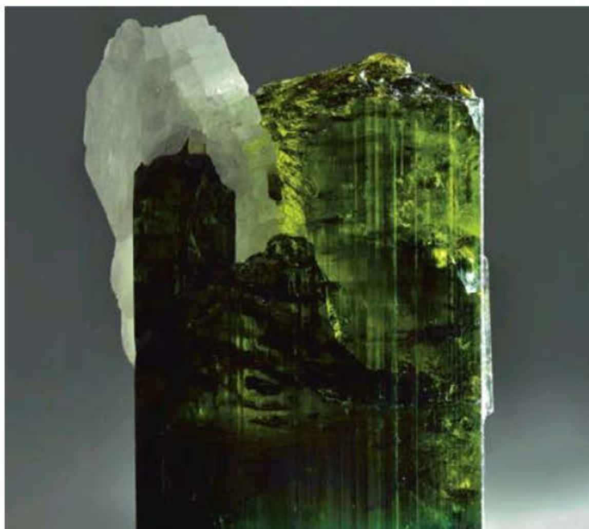
La turmalina es el mineral que más podría asemejarse a los cristales Kyber . Es un material piezoeléctrico, convierte la energía mecánica en eléctrica.
